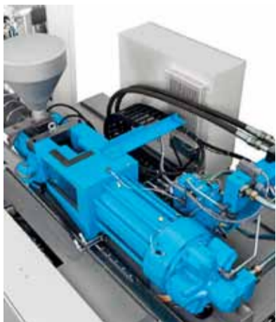
Vstřikovací jednotka je srdcem našeho stroje. Garantuje preciznost a nejvyšší stabilitu procesu
